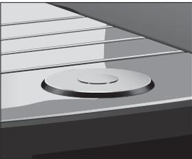
Bedienung über **Rotary Switch**: Nutzen Sie zusätzlich den Rotary Switch. Sobald Sie ihn drehen, wird die Rondell-Ansicht der Produkte angezeigt. Navigieren Sie außerdem durch die Menüpunkte im Programmiermodus und ändern Sie verschiedene Einstellungen.
