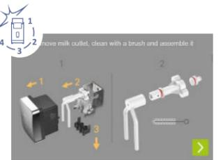
Die Teile wie auf dem Display ausbauen, nach dem Hygienekonzept reinigen und wieder montieren. Befolgen Sie die detaillierte Anleitung „Demontage Milchaufschäumer / Kaffeeauslauf“ auf der Rückseite.
