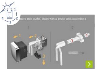
Démonter les pièces tel que décrit à l'écran, nettoyer selon le concept hygiénique et les remonter. Suivre les consignes détaillées « Démontage mousser à lait / sortie de café » apposées sur la face arrière.
