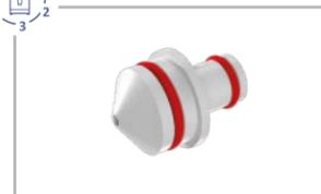
Die Dampfdüse im Milchaufschäumer demontieren und reinigen. Siehe „Demontage Milchaufschäumer“!
