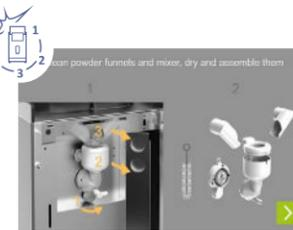
Die Teile wie auf dem Display ausbauen, nach dem Hygienekonzept reinigen und wieder montieren. Befolgen Sie die detaillierte Anleitung „Demontage Instant-Mischeinheit“ auf der Rückseite.
