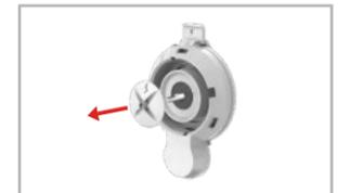
Den Instantmixer demontieren und reinigen. Siehe „Demontage Instantmixer“! Sicherstellen, dass der Instantmischer nach erfolgter Reinigung korrekt eingesetzt wurde.
