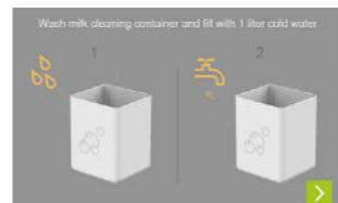
Rincer le récipient de nettoyage et remplir de 1 l d'eau froide. Insérer ensuite le dispositif d'aspiration du lait dans le récipient de nettoyage.
