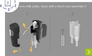
按照螢幕指示拆下組件，並依照衛生概念清潔和更換。請遵循背面所附「拆解奶泡器/咖啡出口」的詳細指示。
