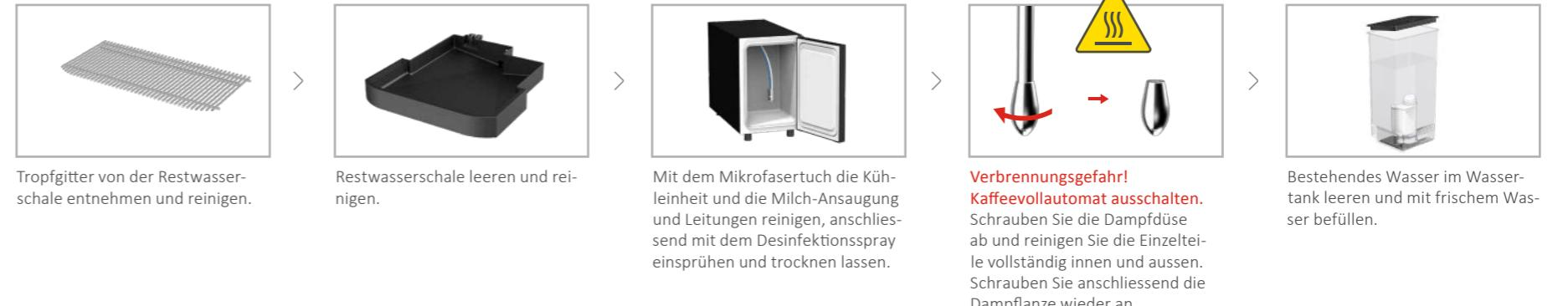
Tropfgitter von der Restwasserschale entnehmen und reinigen.
