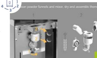
Démonter les pièces tel que décrit à l'écran, nettoyer selon le concept hygiénique et les remonter. Suivre les consignes détaillées « Démontage unité de mélange d'instantané » apposées sur la face arrière.
