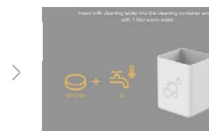
Vul het reinigingsreservoir met 1 liter warm water en laat hierin een melk-reinigingstablet volledig oplossen. Hang vervolgens het melkaanzuigstuk in het reinigingsreservoir. Reinig ook het melkreservoir volgens het hygiëneconcept.
