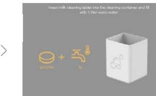
將 1 公升溫水注入清潔容器並加入一顆清潔藥丸，使其完全溶解。將牛奶吸頭浸入清潔容器中。同時依照衛生概念清潔牛奶容器。
