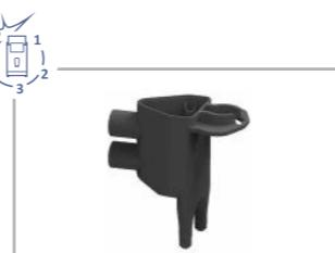
Demonter en reinig de koffie-uitloop. Zie "Koffie-uitloop demonteren"!
