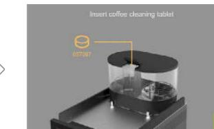
Ouvrir le couvercle pour insertion de pastilles et y placer une pastille de nettoyage café.
