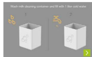
沖洗清潔容器，然後注入 1 公升冷水。將牛奶吸頭浸入清潔容器中。
