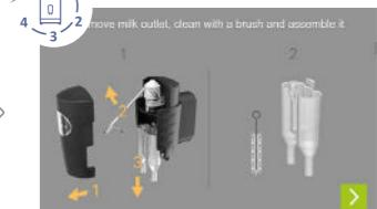
Die Teile wie auf dem Display ausbauen, nach dem Hygienekonzept reinigen und wieder montieren. Befolgen Sie die detaillierte Anleitung „Demontage Milchaufschäumer / Kaffeauslauf“ auf der Rückseite.
