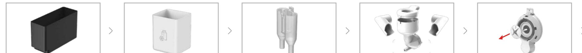
Den Satzbehälter leeren und reinigen.
