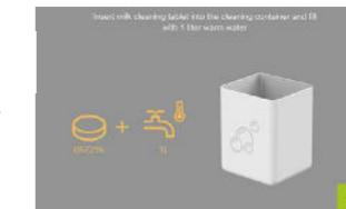
Remplir le récipient de nettoyage de 1 l d'eau chaude et y dissoudre complètement une pastille de nettoyage lait. Insérer ensuite le dispositif d'aspiration du lait dans le récipient de nettoyage.
